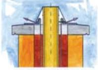
Hinterlüftung oder Gegenstrombetrieb möglich
